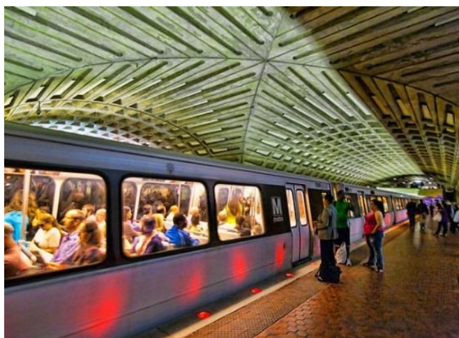
Foto 12. Belysning från plattformsgolv i en av Washington DC:s tunnelbana stationer (tagit från Bestourism.com)
