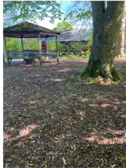
Figur 10 :En mötesplats i Fredrikdal där underlaget består av träflis, kvistar och rötter vilket gör det svårt att ta sig fram med rullstol eller barnvagn. Det saknas hårdgjorda gångytor, vilket gör platsen otillgänglig.
